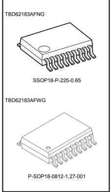
Weight SSOP18-P-225-0.65 : 0.09 g (Typ.) P-SOP18-0812-1.27-001 : 0.48 g (Typ.)
